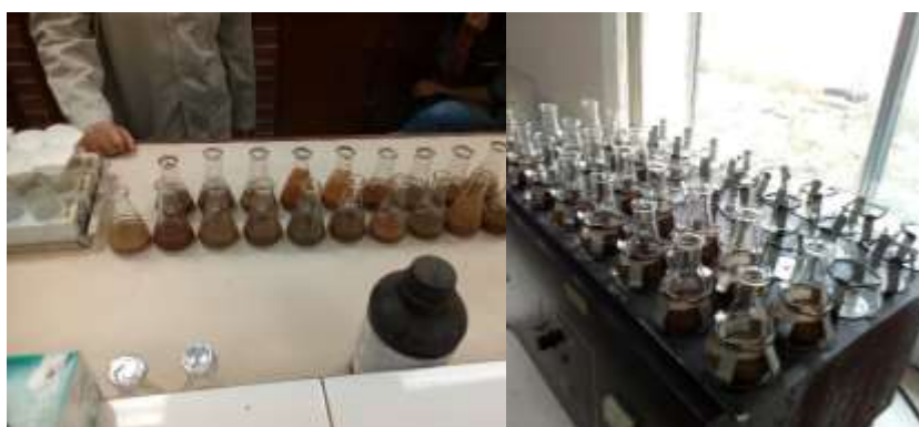
Figura 14A. Proceso de agitación de muestras de suelo durante el análisis químico. Laboratorio de suelos, ICTA.
