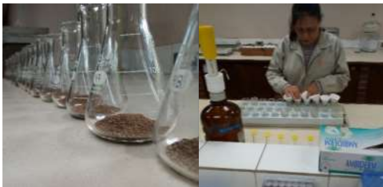
Figura 13A. Análisis de suelo con las diferentes metodologías de extracción para la determinación de fósforo disponible. Laboratorio de suelos, ICTA.
