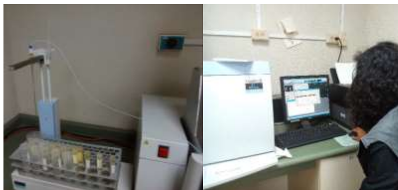
Figura 15A. Determinación química de elementos del suelo por espectrofotometría de absorción atómica. Laboratorio de suelos, ICTA.
