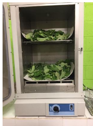
Figura 4. Secado de hojas de loroco en horno de convección, en el laboratorio de agua de CUNORI.
