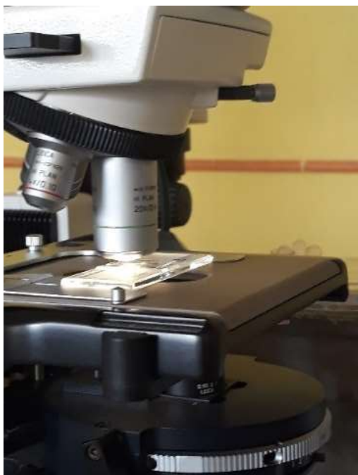
Figura A. 19. Conteo de esporas de antracnosis. Laboratorio Protección Vegetal, ICTA, Quetzaltenango, Guatemala, 2019 Con la cámara de Neubauer. A razón de 1.2 x 10 6 conidias/ml.
